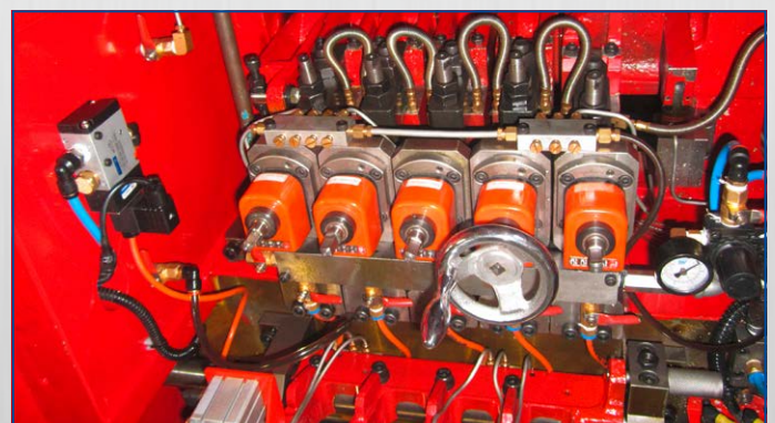
Matrizenseitige Auswerferseinstellung mit Handrad und Zähler Matrix-side KO adjustment with handwheel and counter / Réglage éjecteur de matrices latérales avec volant et compteur
